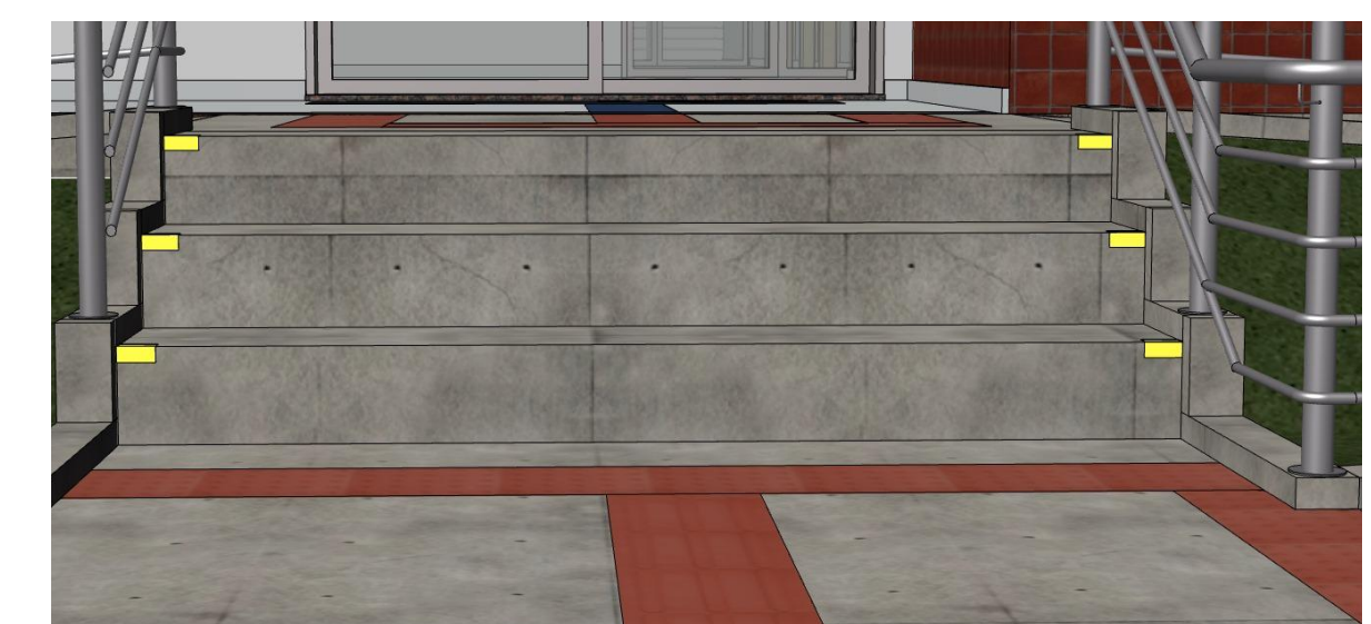
Perspectiva - Sinalização de escadas NBR 9050:2015
