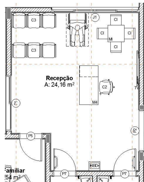
Figura 2 – Planta baixa da Recepção.
