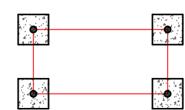
DETALHE EQUIPAMENTO MULTIPLO EXERCITADOR FUNDAÇÃO EM VISTA
